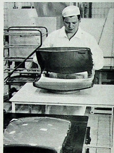
Bild 3. Einsetzen der Lochmaske vor der Belichtung
